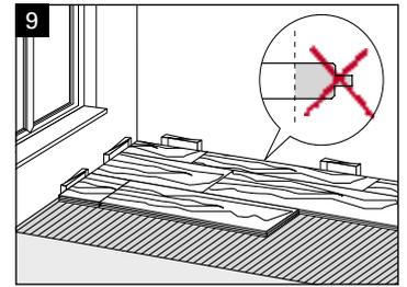
Das jeweils letzte Element einer Reihe wird abgesägt und mit dem Reststück, das nicht kürzer als 15 cm sein soll (Bild 11), wird die nächste Reihe begonnen. Das letzte Element wird mit einem Zugeisen und einem Hammer gefügt (Bild 10). Die Quertugen sollten von Reihe zu Reihe mindestens 15 cm verspringen (Bild 12 „wilder Verband“).
