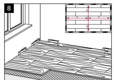
Entfernen Sie zuerst die Längsfedern der gesamten ersten Dielenreihe (Bild 9) mit einer Säge, sofern Sie die erste Reihe nicht sowieso schmälern müssen. Beginnen Sie die erste Reihe in einer linken Raumecke und legen Sie die abgeschnittene Längsseite zur Wand. Der erforderliche Wandabstand von 8 bis 10 mm wird durch die Parador Kunststoff-Rastkeile erreicht.
