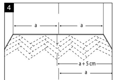
Tipp: Um die ersten Dielen einfach und im richtigem Winkel zueinander zu verlegen, gehen Sie bitte wie folgt vor: Legen Sie zunächst die Dielen A und 1 mit einem Versatz von ca. 120 mm zusammen. Diele A dient nur als Anlage und wird später wieder entfernt. Danach verlegen Sie die Dielen 3 und 4. Jetzt können Sie Diele A wieder entfernen und die restlichen Dielen entsprechend der Nummerierung verlegen (Bild 5).
