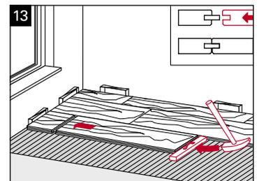
Der Boden ist nach der Verlegung und Leimaushärtung sofort bezugsfertig. Sie müssen nur noch die Parador Kunststoff-Rastkeile entfernen und Parador Sockelleisten mit der patentierten Cliptechnik oder dem Parador Montagekleber anbringen.
