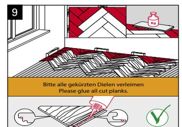
Sollte die relative Luftfeuchtigkeit im Raum nicht zwischen 30 % - 65 % liegen, verleimen Sie bitte alle Dielen miteinander. Das Gleiche gilt, sofern Sie den Boden auf einer Fußbodenheizung verlegen.
